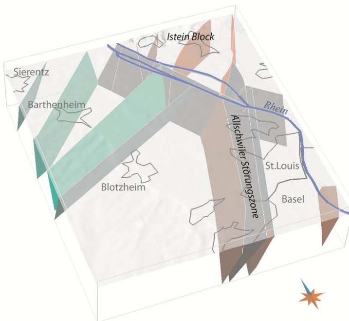
Abb. 3.5.11.3-3 Übersicht Fall B. Grüne Störungen wurden von Fall A zu Fall B verändert. Braune Störungen wurden nicht verändert. Modelldimensionen: ca. 10 km x 11 km x 2,3 km
