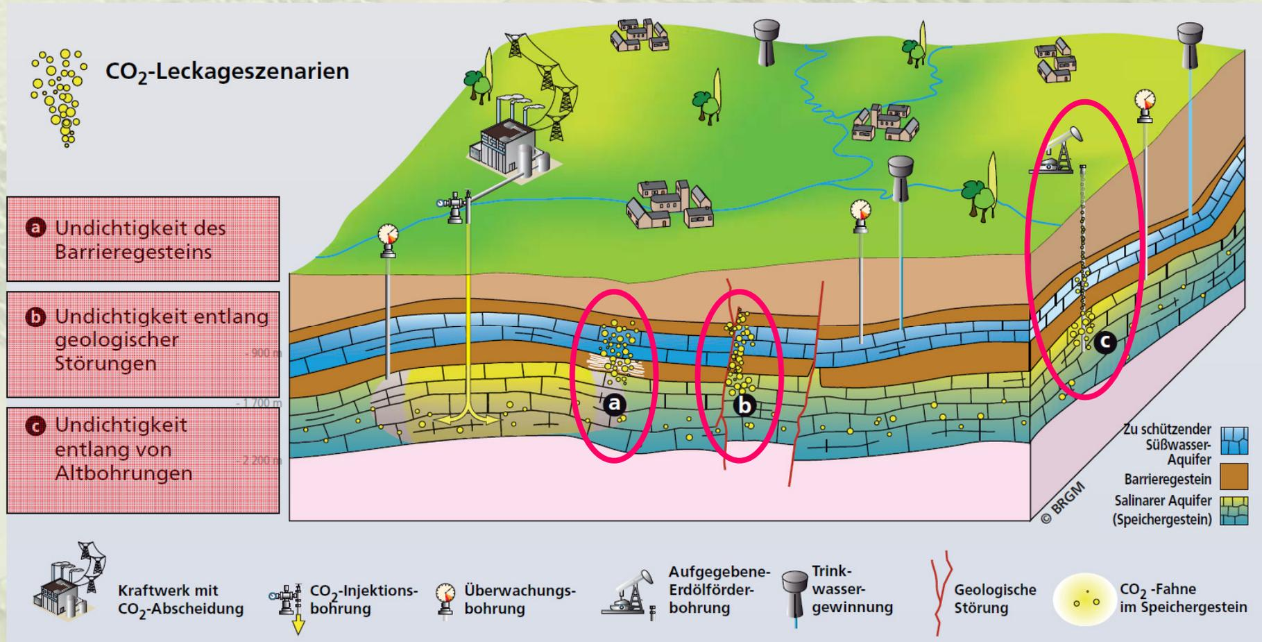
**Etanchéité insuffisante dans les roches ciblées pour le colmatage**
